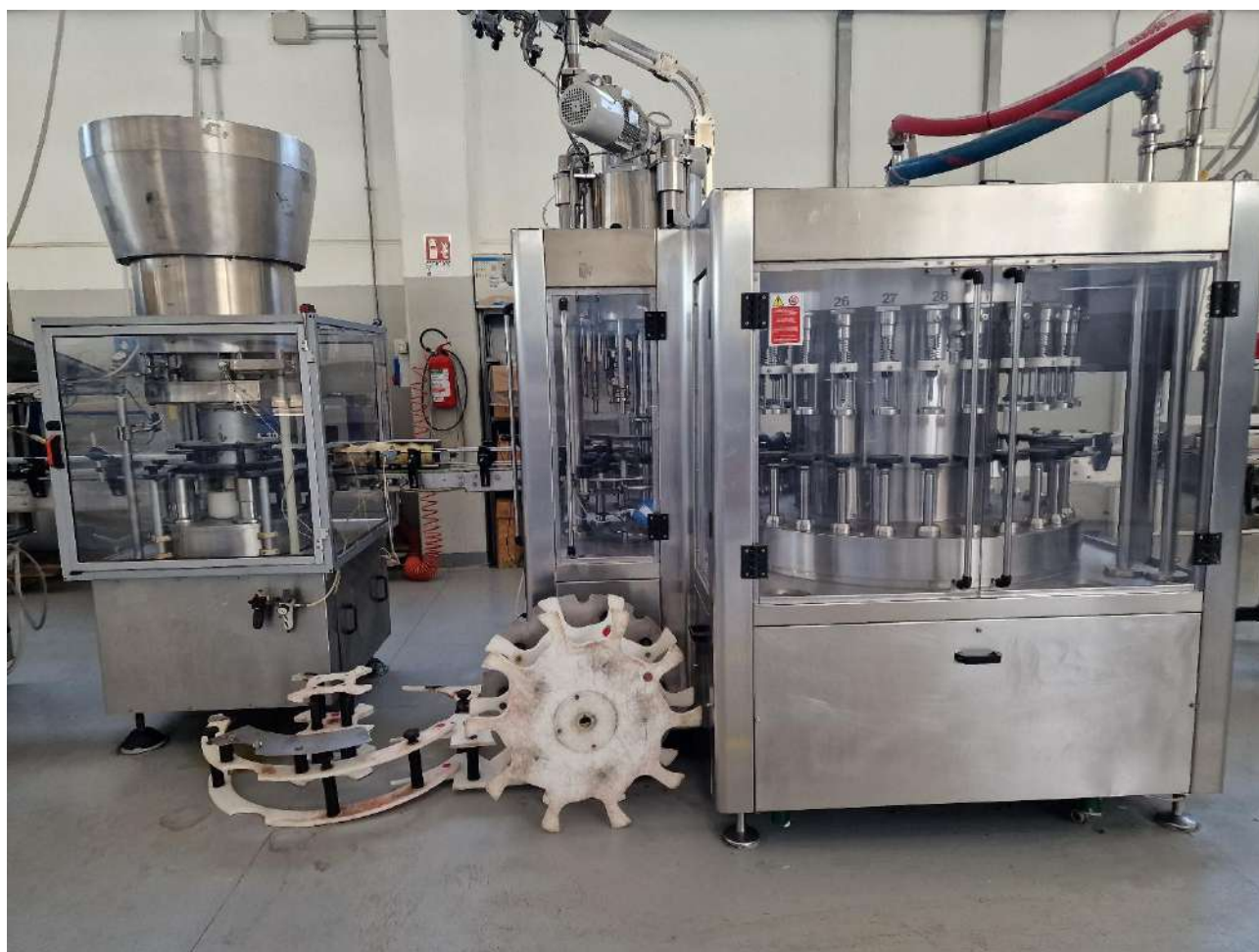
5- MACCHINA RIEMPITRICE FIMER COMPENSIVA DI NASTRO
