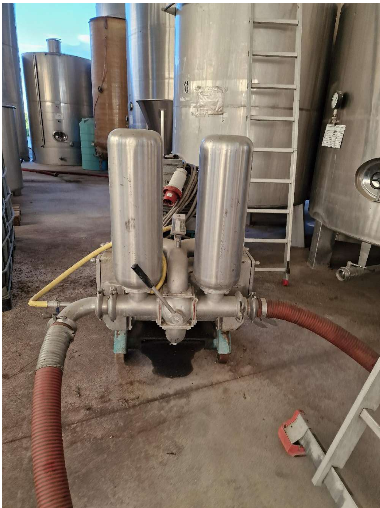
47- POMPE DA TRAVASO
